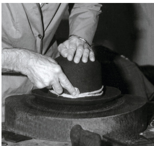
Oblikovanje tulca za klobuk na modelu, pritrjenem na leseni plošči, »zotlu«. Okrog oglavja je klobučar zavezal vrvico, »formpantel«, s posebnim nožičkom iz medenine, »trabajznom«, pa je naredil rob med oglavjem in okrajem (hrani Loški muzej Škofja Loka).
