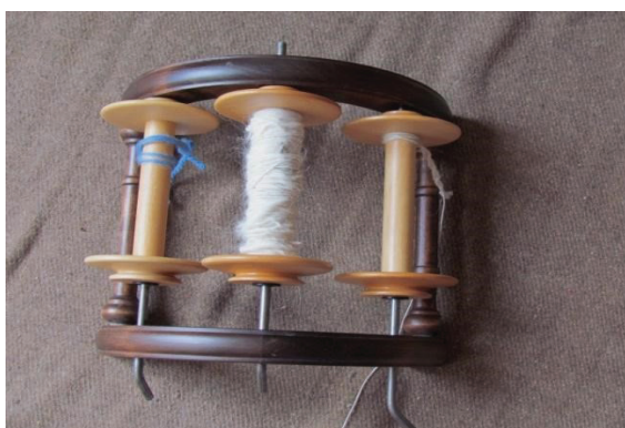
Na fotografiji je stojalo za vretena, ki omogoča sukanje do treh niti. Po angleško se imenuje lazy Kate, jaz pa mu pravim kar »lena Katar«.
