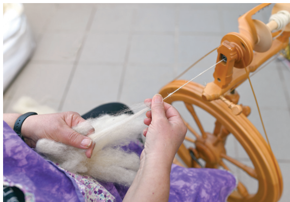
Počasi in neprekinjeno spuščamo sukano prejo proti grlu kolovrata in se ponovno odmaknemo nazaj.
