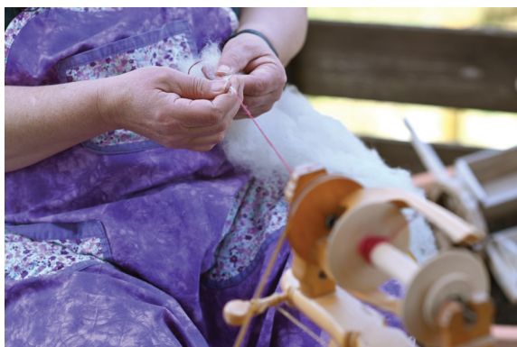
Začetno nit povlečemo skozi grlo kolovrata in nanjo začnemo sukati zmikano volno.
