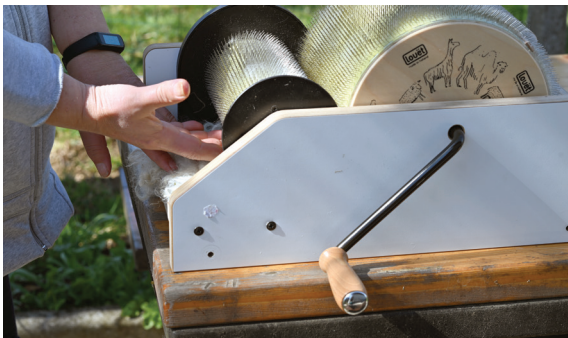
Pri podajanju runa v boben pazimo na položaj roke in prstov, da se ne poškodujemo.
