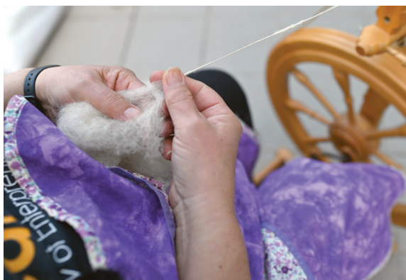
V levi roki držimo runo, z desno pa stiskamo posukano prejo in tako določamo stopnjo posukanja.
