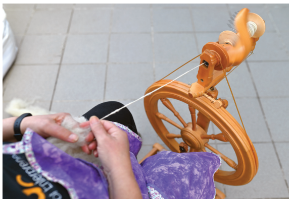
Počasneje spuščamo prejo proti kolovratu, bolj bo posukana.
