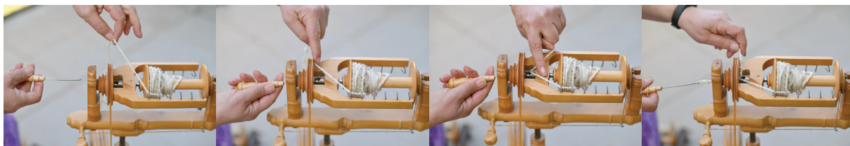
Začetno nit povlečemo skozi grlo kolovrata in nanjo začnemo sukati zmikano volno.
