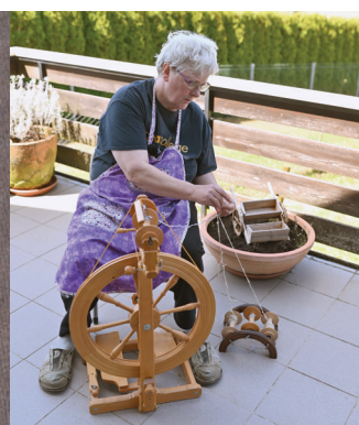
Na fotografiji je stojalo za vretena, ki omogoča sukanje do treh niti. Po angleško se imenuje lazy Kate, jaz pa mu pravim kar »lena Katar«.
